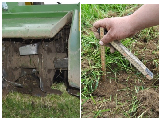
Tangentiale Anordnung der Messer
