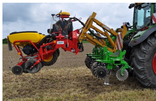
Striptill - Saatverfahren ist Boden schonend und preisgünstiger als die Streifenfrässaat
