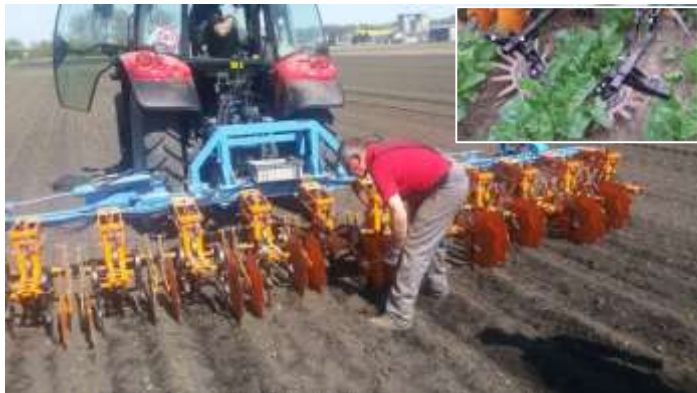
Sarcluse schmotzer avec désherbage dans la ligne (doigts) et inter-rangs (dents)
