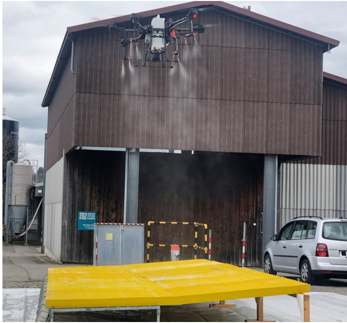
Distribution transversale de drones de pulvérisation | Journée phytosanitaire grandes cultures 2024 Thomas Anken | © Agroscope
