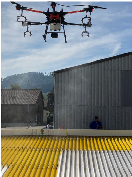
Banc d'essai à gouttières 3 x 6 m
