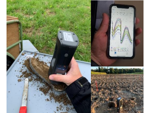
NeoSpectra Scanner (1350-2500 nm, 16 nm Auflösung)
