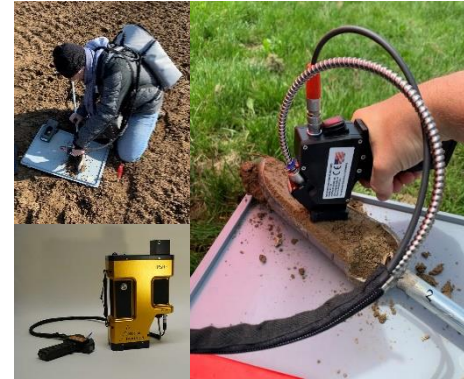
PSR+ 3500 vis-NIR Spektrometer (350-2500 nm, 2.8-8 nm Auflösung)
