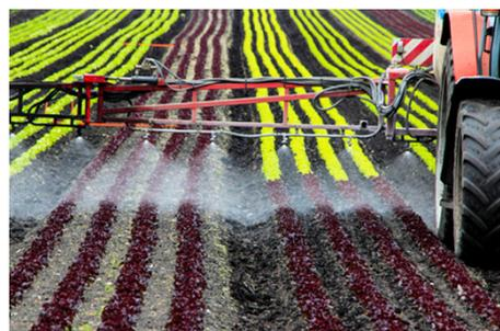
Abb. 1: Flächige Applikation mit dem Feldbalken – Standard.
