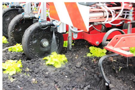
Abb. 2: Einzelpflanzenbehandlung mit dem Steketee IC Weeder-Prototyp in Salat.
