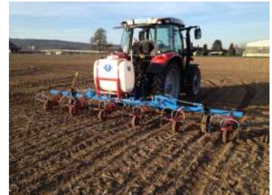
Bandspritzgerät mit einer Arbeitsbreite von 6 m mit 12 Flachstrahldüsen vom Type ES von Lechner
