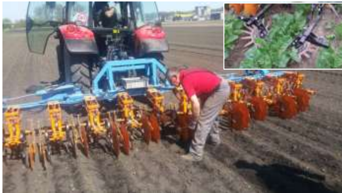
12-reihiges Hackgerät von Schmotzer mit Fingerhackelementen für die Unkrautbekämpfung in den Reihen
