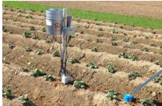
Adcon A755, Enregistreur de données avec connexion au réseau cellulaire
