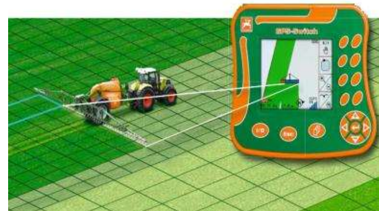
Feld: Parallelfahren, Spritzen und Düngen mit Section Control (An-/Abschalten)
